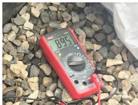
Foto 12: Medición del conductímetro en primer ensayo
