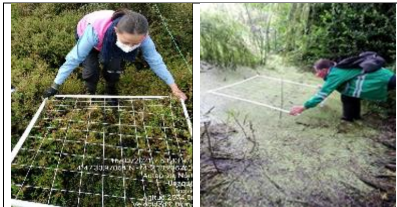
Figura 1. Unidad de Muestreo 1m 2 , para el muestreo de macrófitas y herbazales. Fuente: Grupo de monitoreo de la biodiversidad.
